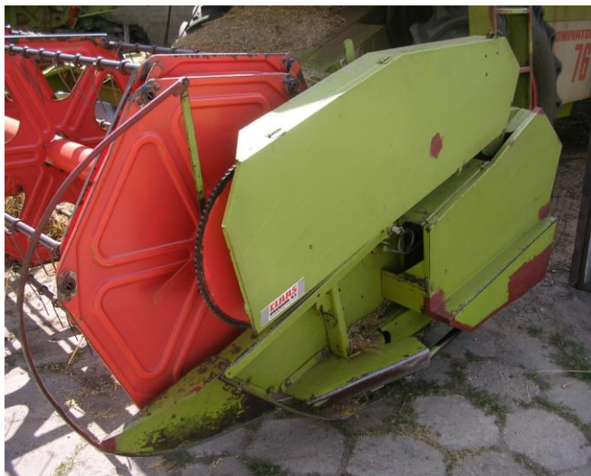
Osłony na elementach niebezpiecznych kombajnu muszą być kompletne i nieuszkodzone
