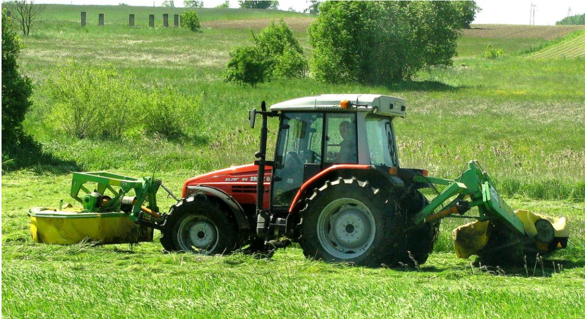
Kosiarki muszą być wyposażone w fartuchy zabezpieczające przed uderzeniem kamieniami lub innymi przedmiotami, wyrzucanymi spod maszyny
