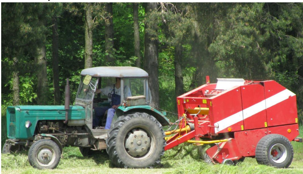
Komplet osłon na wałach przegubowo-teleskopowych, zapewni bezpieczną pracę
