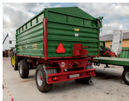
Trójkątna tablica wyróżniająca pojazd wolno poruszający się – na tylnej burcie przyczepy.
