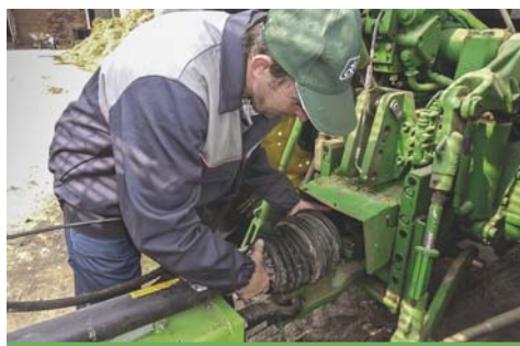
Podłączenie wału przegubowo-teleskopowego do napędu rozrzutnika.
