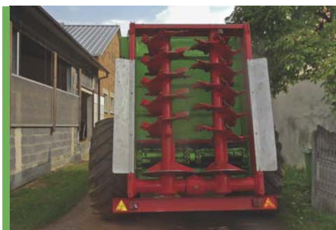
Przejazd z rozrzutnikiem wyposażonym w zastawę skrzyni w pozycji zamkniętej.
