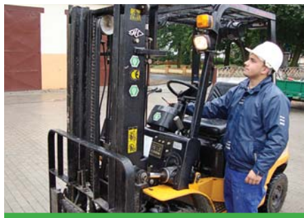
Sprawdzenie powinno również obejmować oświetlenie.
