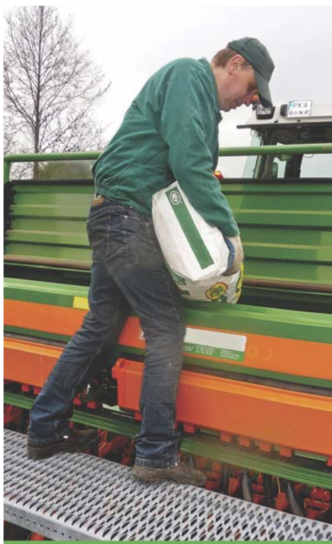
Napełnianie zbiornika z platformy załadunkowej, po opuszczeniu do położenia roboczego.
