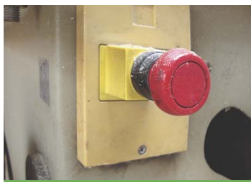
Przycisk zatrzymania awaryjnego (w kształcie grzybka o barwie czerwonej na żółtym tle).
