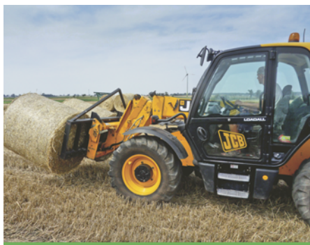
Przejazd z opuszczonym i wsuniętym ramieniem wysięgnika zwiększa widoczność.
