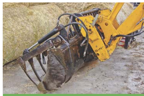
Podczas odłączania osprzętu narzędzie powinno spoczywać stabilnie na podłożu.
